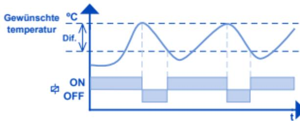
Betrieb in der Annäherungssteuerung - Die Temperaturregelung erfolgt im EIN/AUS-Modus und in der PID-Regelung. Sie wird eingeschaltet, wenn die Umgebungstemperatur weiter vom eingestellten Differenzial entfernt ist. Wenn die Temperatur innerhalb des Differenzwertes liegt, erfolgt die Steuerung durch Annäherung, um den eingestellten Wert nicht zu überschreiten (PID-Regelung). Das System schaltet ab, wenn die Temperatur den eingestellten Wert erreicht.
